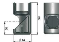
TM-RAM-CS Right angle mirror
